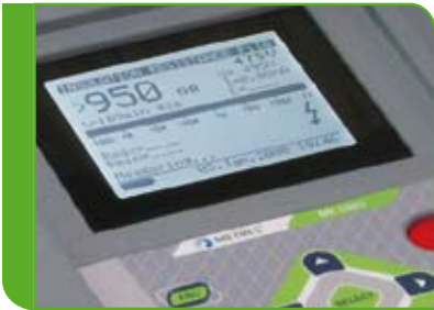
Zamana karşı Direnç grafiğine uygun gerçek zamanlı direnç ölçümü
